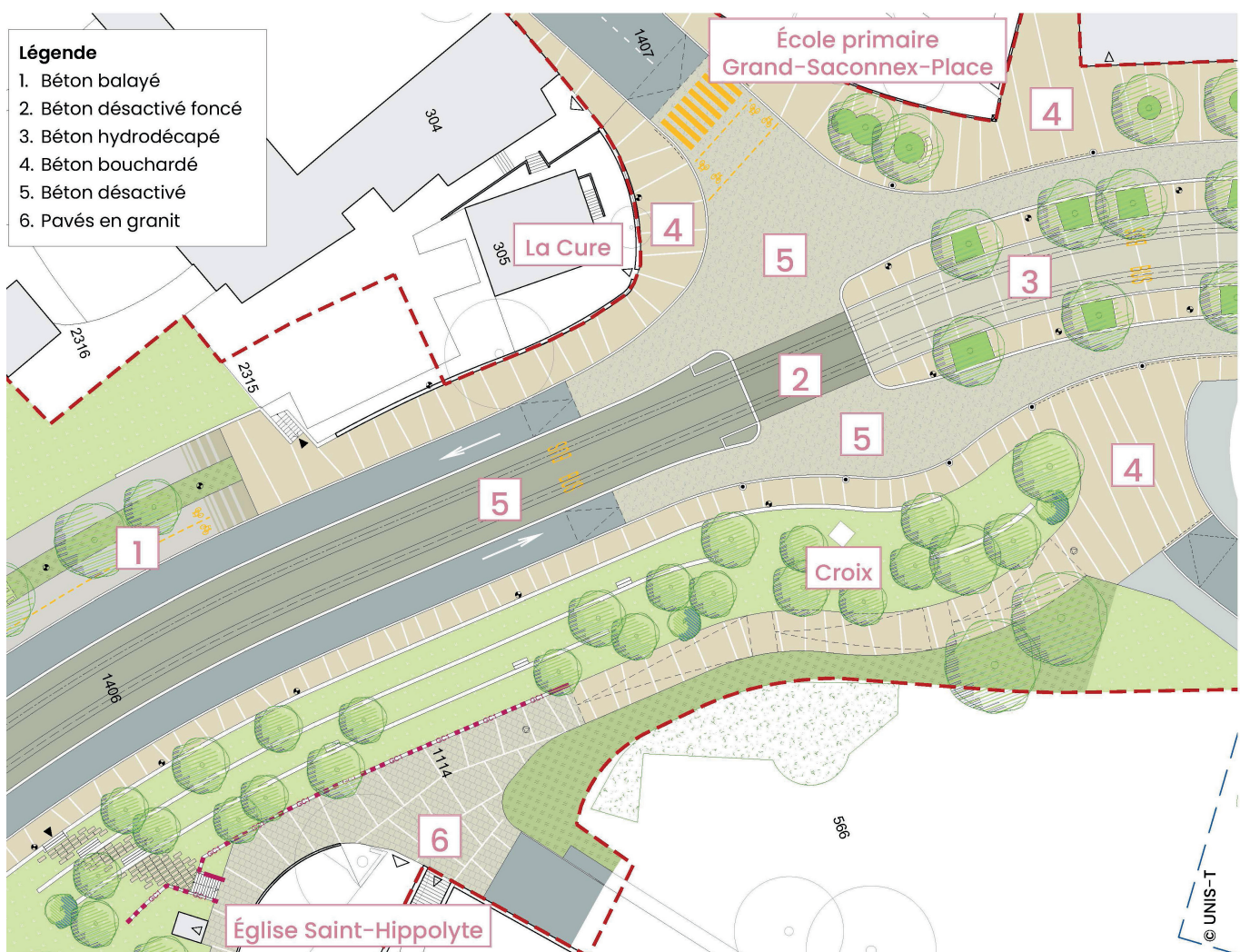
Plan des revêtements du secteur SUD de la Place Carantec avec indications des traitements de surface
